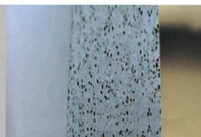
砂輪表面有明顯的氣孔
