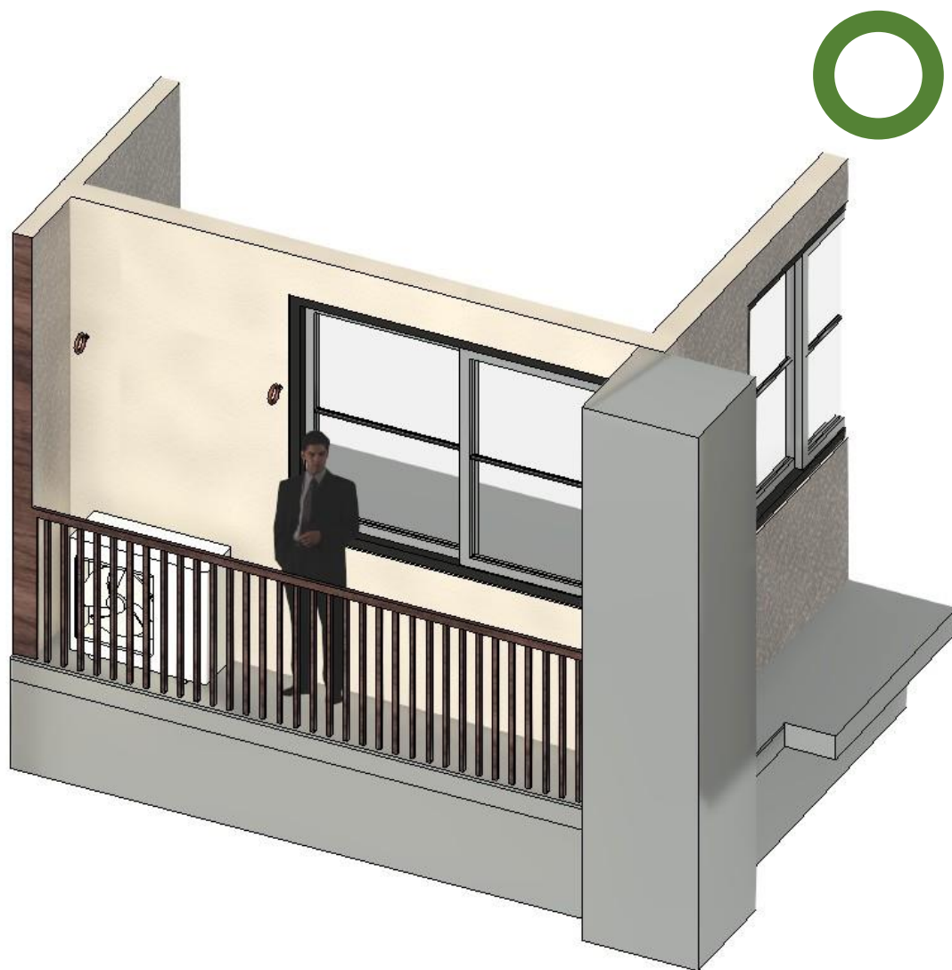
圖 2-2、露樑設置室外機範例
