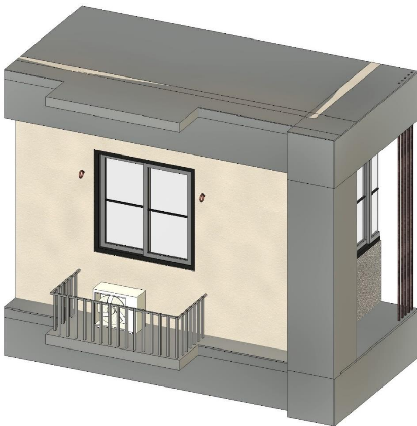
圖 2-1、雨遮設置室外機範例
