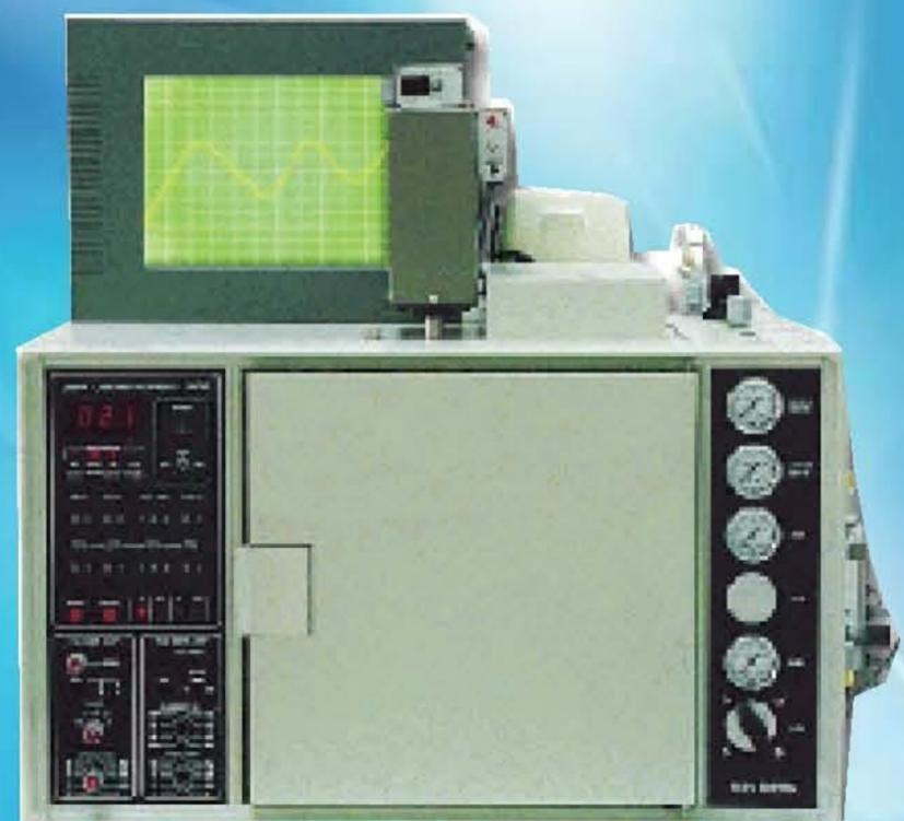
本設備之檢測方法除依據現行環保法規所訂定揮發性有機物廢氣排放管道需安裝THC及NMHC等有機物濃度監測系統之公告系統檢測方法，更具備一些毒性碳氫化合物成分氣體濃度的定量、定性量測。此項量測功能主要取決於本系統之GC氣相層析儀架構及工研院開發，並取得國內、國外專利之量測方法及分析軟體。
