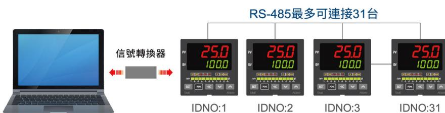
相容Modbus RTU通訊協議，可與市面上所有人機界面、PLC和SCADA軟體快速建立連結。
