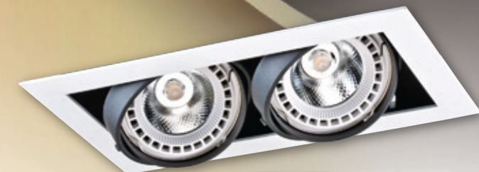
嵌入孔 315x170 mm AL25016 6670 L350mm W205mm H85mm 附COB LED 12wx2、黃光 鋁框、科銳晶片
