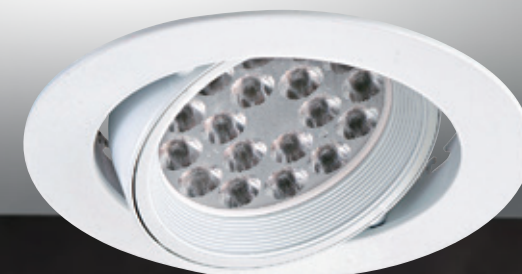
嵌入孔 ø150mm AL25091 5200 W170mm H80mm 附高亮度原裝進口 OSRAM LED 26w AC100V-240V (台灣電子 PF>0.9 ) 3000K / 流明2700Lm 鋁
