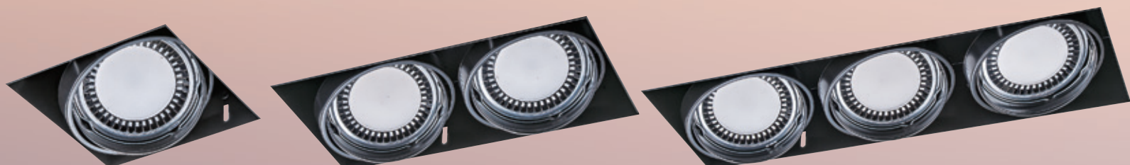
AL25027 4340 L161mm W161mm H90mm 附高亮度原裝進口 OSRAM LED 18wx1 AC100V-240V (台灣電子) 3000K、流明1800Lm 鋼材 (台灣製造)、散光 無邊框請準確開孔
