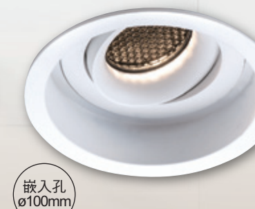
AL2507A 3900 W111mm H125mm 附 CREE CXA 18w模組 3000K、4000K、5700K 鋁材、粉體烤漆
