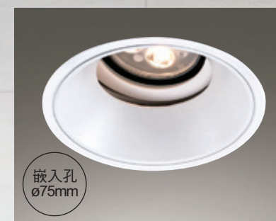
AL25071 2600 W81mm H105mm 附LED 6珠 8w OSRAM 3030 3000K、4000K、5700K 鋁材、粉體烤漆（細邊框）
