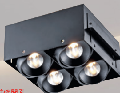
AL25062 7900 L206mm W106mm H95mm 附美國科銳晶片 15wx2 CREE CXA COB 15w模組 3000K、4000K、5700K 鋼鐵鋁材、台製驅動、無邊框請準確開孔
