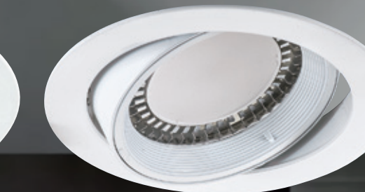
嵌入孔 ø150mm AL25093 4340 W170mm H80mm 附高亮度原裝進口 OSRAM LED 18w AC100V-240V (台灣電子) 3000K / 流明1800Lm 鋁 (散光)
