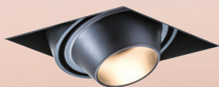
AL2506B 2700 L106mm W106mm H85mm 附LED 4珠 6w OSRAM 3030 4珠 6w 3000K、4000K、5700K 鋁材、粉體烤漆、無邊框請準確開孔
