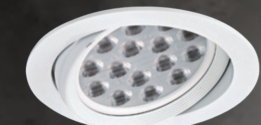
嵌入孔 ø130mm AL25094 4000 W150mm H60mm 附高亮度原裝進口 OSRAM LED 21w AC100V-240V (台灣電子 PF>0.9 ) 3000K / 流明2250Lm 鋁
