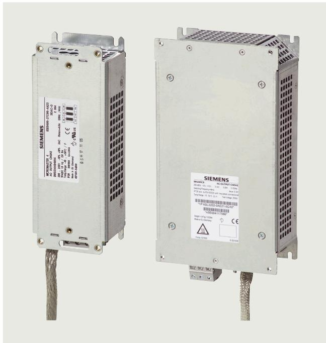
输出电抗器能够降低电机绕组的电压负载。此外，电机电缆较长时，电容充放电电流会对功率单元造成额外的负载，而输出电抗器有助于缓解此效应。
