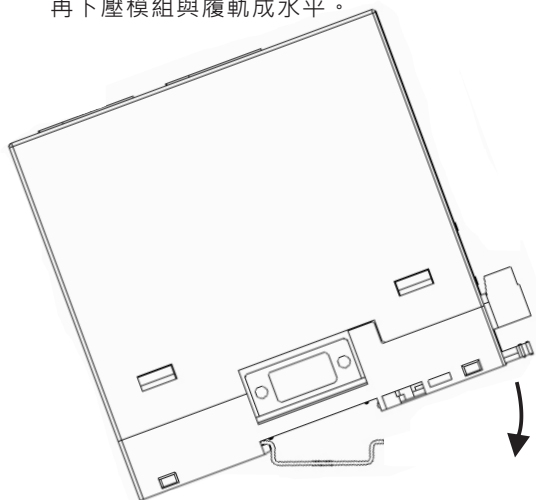
圖. 1 將模組向左傾斜，底座卡入履軌內。 再下壓模組與履軌成水平。
