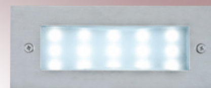
AL26735 3600 W170mm H70mm D55mm 附LED 2wx1、暖白、全電壓 鋁合金壓鑄成型、不鏽鋼面蓋 不鏽鋼本色、拋光拉絲處理 噴砂玻璃、附ABS預埋盒 預埋盒： W155mm H55mm D52mm
