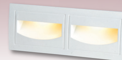
AL2673B 7200 W213mm H83mm D52mm 附LED 3wx2、暖白、全電壓 鋁合金壓鑄組裝成型、白色 透明玻璃、附ABS預埋盒 預埋盒：W203mm H75mm D47mm
