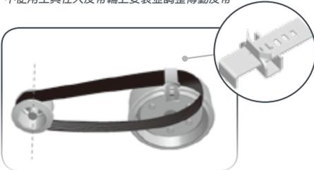
使用SNAP ON工具在大皮帶輪上安裝並調整傳動皮帶
