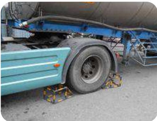
檢查槽車車輪是否有放置輪檔固定
