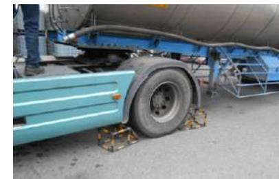
03 檢查槽車車輪是否有放置輪檔固定
