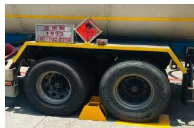
03 檢查槽車車輪是否有放置輪檔固定
