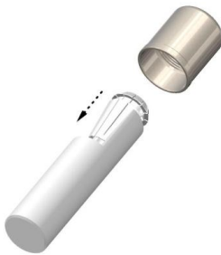
W-CRT拆出筒夾步驟四 REMOVE COLLET STEP 4
