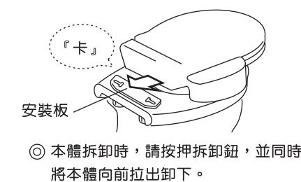
◎ 本體拆卸時，請按押拆卸鈕，並同時將本體向前拉出卸下。
