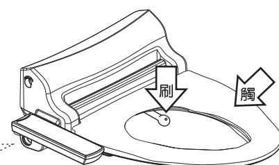
1 拉出噴嘴頭後用刷子輕刷表面以清除表面和孔洞內的污垢及水垢。
