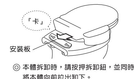
◎ 本體拆卸時，請按壓拆卸鈕，並同時將本體向前拉出卸下。
