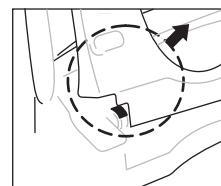
**警告** 因便座右側銜接處有保護連接線的固定浪管，便座只可稍微離開本體以便清潔，不可強制將浪管拉出。
