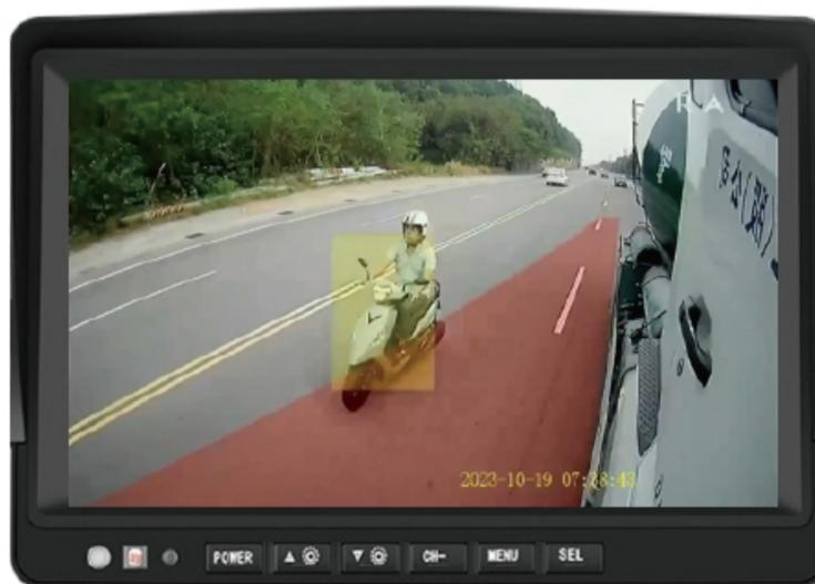
▲ 透過車內螢幕可見偵測區塊，將鏡頭角度調整至**警示區塊**需與車身貼齊(如圖)，偵測區塊尾端角度需調整至車尾處。
