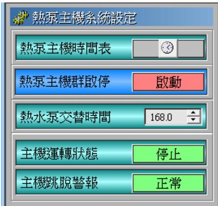
熱泵主機系統依時間表啟停，熱水泵同樣依據交替時間設定進行切換，目前熱泵冷卻水泵及熱泵冰水泵由熱泵主機依設定模式自主控制，未由本圖控系統控制。
